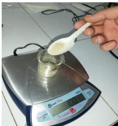
Fig. Nr. 36 Cântărire la balanta tehnică, câte 10 gr. de sol mojarat (original)
