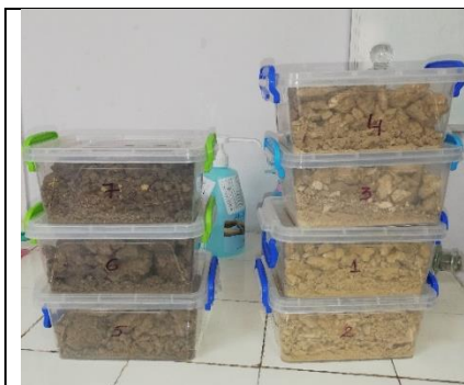
Fig. Nr. 36 Pregătirea probelor de sol (original)
