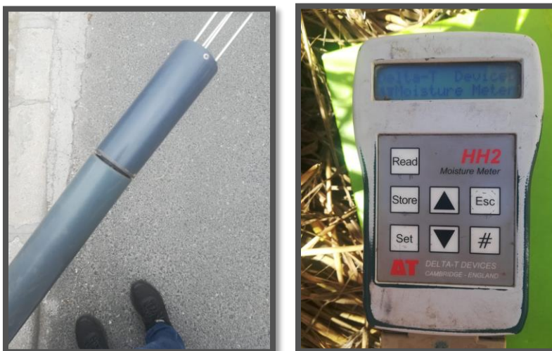
Figura 4 - Sondă pentru măsurarea umidității solului Theta Probe - ML2x/d
